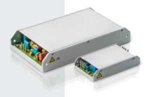
МАА-СГ (СД) компактные АС/DС-преобразователи 30–3000 Вт, температурный диапазон эксплуатации –50...+85°С, одно- и трёхфазные входные сети, КПД до 94%.
