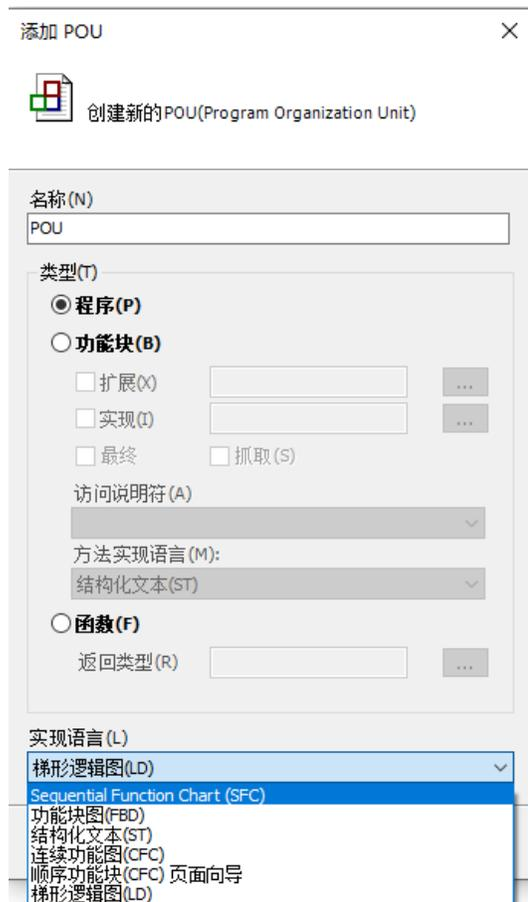
Среда программирования CodeSys [соответствует IEC 61131 - 3](#) и поддерживает список команд (IL), лестничную диаграмму (LD), структурированный текст (ST), функциональную блок - схему (FBD), функциональную схему последовательности (SFC).
