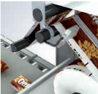
Надежное обнаружение стандартных или полупрозрачных меток при нормальной или высокой скорости движения
