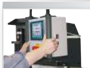
Поворотный пульт управления с двуручным управлением
