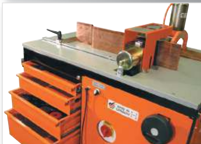
В тележке предусмотрено 4 выдвижных ящика для инструментов со специальными отделениями для пуансонов и матриц.
