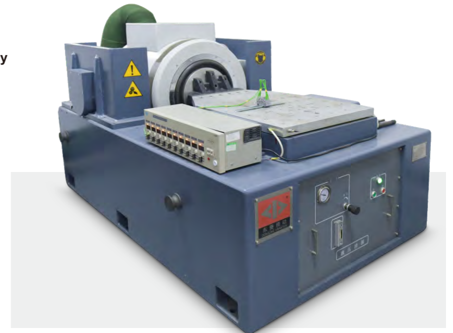
Испытательная установка для вибрационных нагрузок
