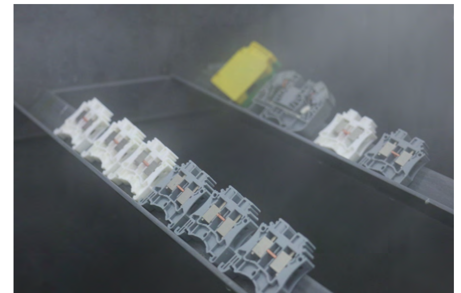
Испытание на коррозию в солевом тумане клемм на DIN-рейку
