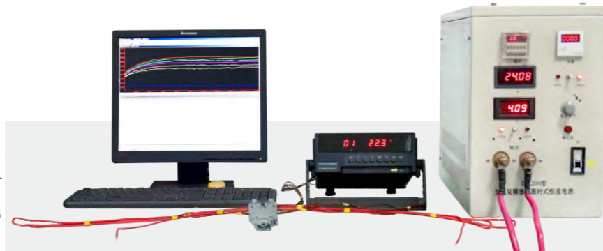
Испытание на нагрев клемм под нагрузкой
