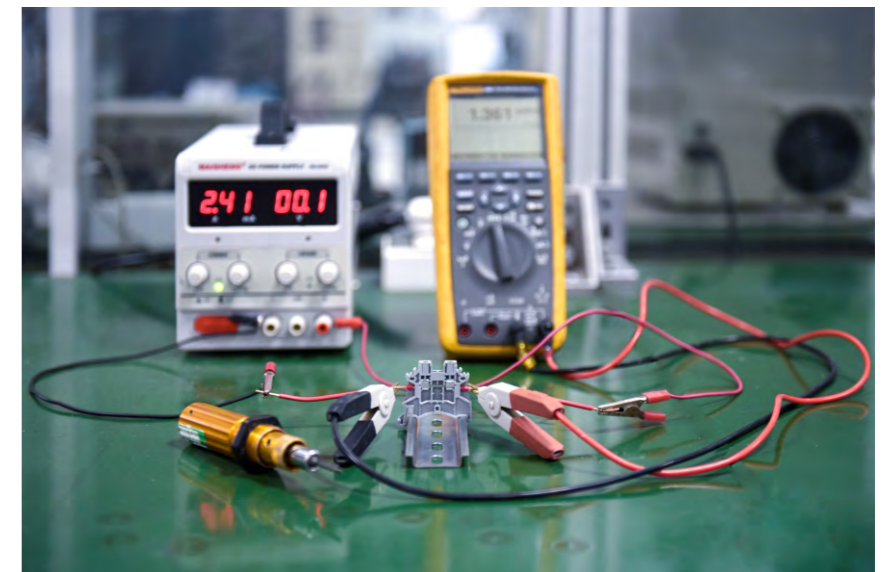
Испытание винтовых клемм на падение напряжения
