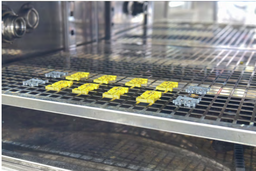
Циклические температурные испытания клемм на DIN-рейку
