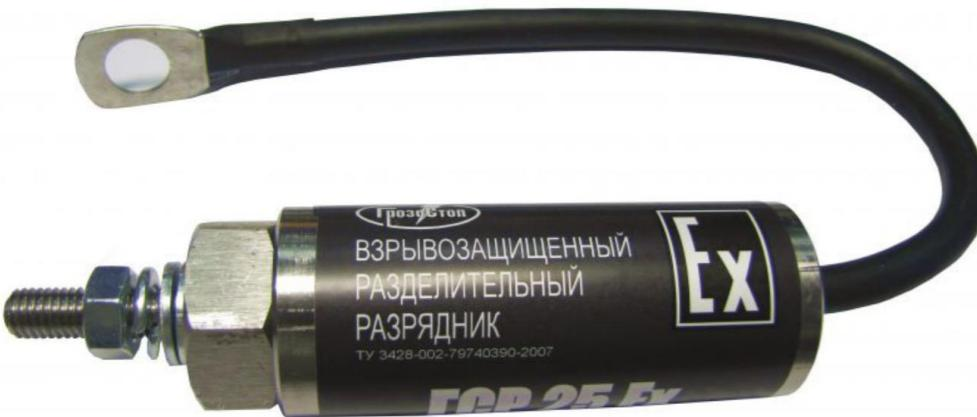
Взрывозащищенный разделительный разрядник для уравнивания потенциалов во взрывоопасных зонах.  $i_{imp}(10/350) = 25$  кА. Подключение с помощью кабельного наконечника и монтажной шпильки. Применяется в трубопроводных системах.
