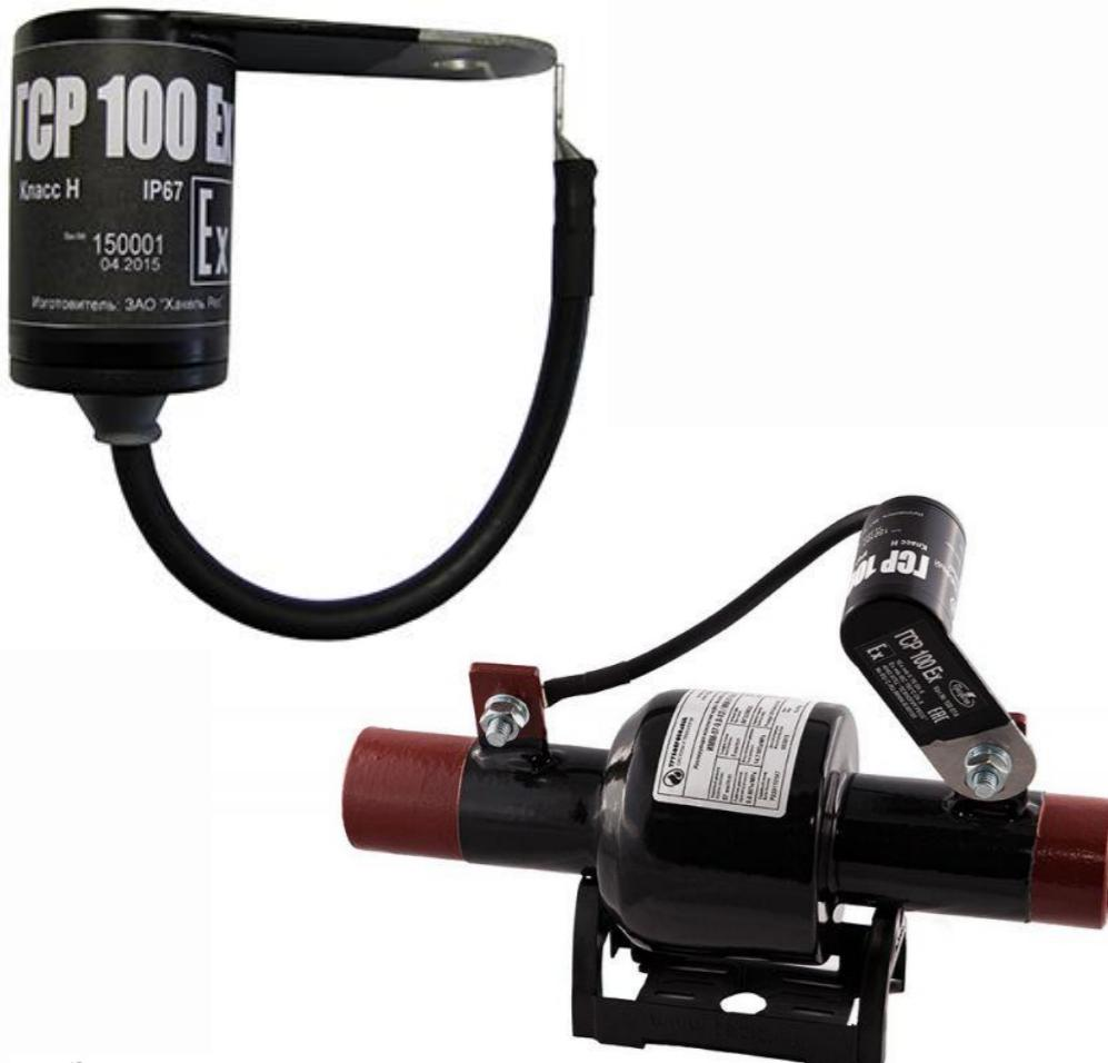
Взрывозащищенный разделительный разрядник для уравнивания потенциалов во взрывоопасных зонах.  $i_{imp}(10/350)=100$  кА. Подключение с помощью клеммного наконечника и монтажной пластины. Применяется в молниезащите и трубопроводных системах.
