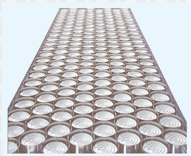
Рис.27. Нагревательная панель для нагрева доньшек бутылок
