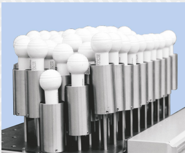
Рис. 8: Трехмерная нагревательная панель для ламинирования наличников дверей
