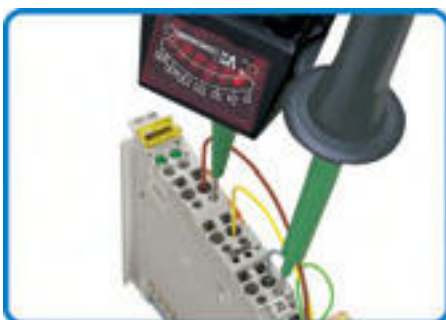
Проверка прохождения сигнала при подсоединенных проводниках
