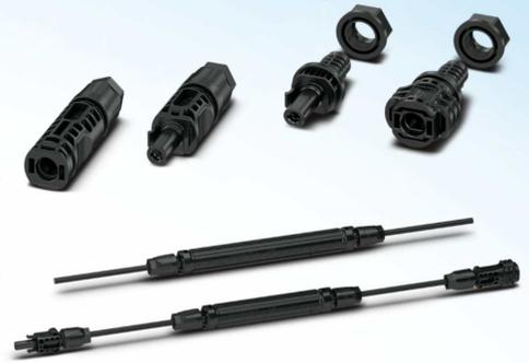
Кроме того, имеются новые штекерные соединители Sunclix с обжимным соединением для кабельной разводки фотогальванических модулей. Новые исполнения можно обрабатывать в (полу)автоматическом режиме. Посеребренные контакты гарантируют более низкое контактное сопротивление при длительной эксплуатации. Новые штекерные соединители с обжимным соединением рассчитаны на ток до 40 А (TÜV)/50 А (UL) и напряжение до 1500 В (TÜV/UL).
